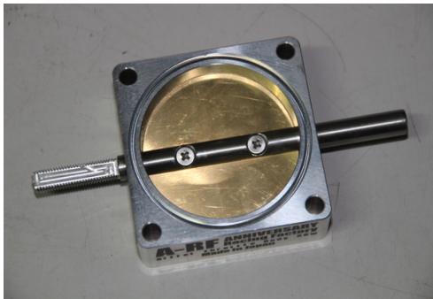
バタフライを固定 バタフライ固定ネジにはネジロックを使用・
