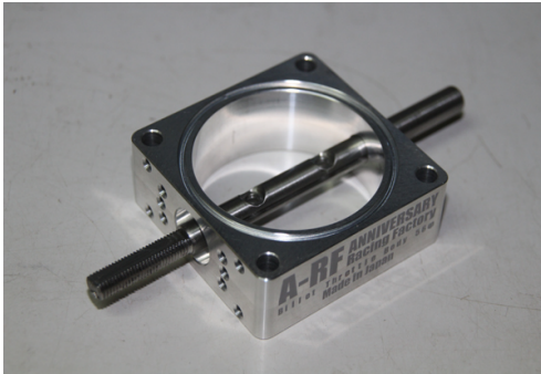
スロットルボディーにシャフトを挿入
